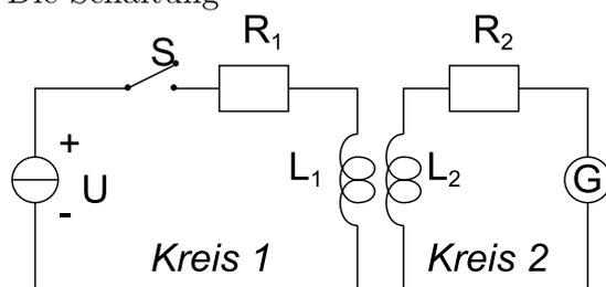
habe einen Widerstand von  $R_1 = 200\Omega$  sowie  $R_2 = 300\Omega$ . Wenn der Schalter  $S$  im Kreis 1 geschlossen wird, fließt im Kreis 2 die Gesamtladung  $Q = 2 \cdot 10^{-4}C$  durch das Galvanometer. Nach langer Zeit betrage die Stromstärke im ersten Kreis  $5A$ . Berechnen Sie die Gegeninduktivität der beiden Spulen.
