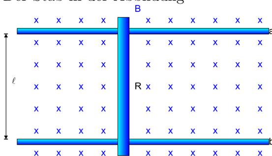
habe den Widerstand  $R$  und der Widerstand der Schienen sowie die Kontaktwiderstände seien vernachlässigbar. An die Punkte  $a$  und  $b$  werde eine Spannungsquelle mit vernachlässigbarem Innenwiderstand so angeschlossen, dass der Strom im Stab nach unten fließt. Zum Zeitpunkt  $t = 0$  sei der Stab in Ruhe.
