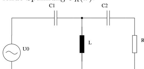
2. Berechnen Sie für die unten stehende Schaltung die an allen Bauteilen abfallenden Spannungen.
