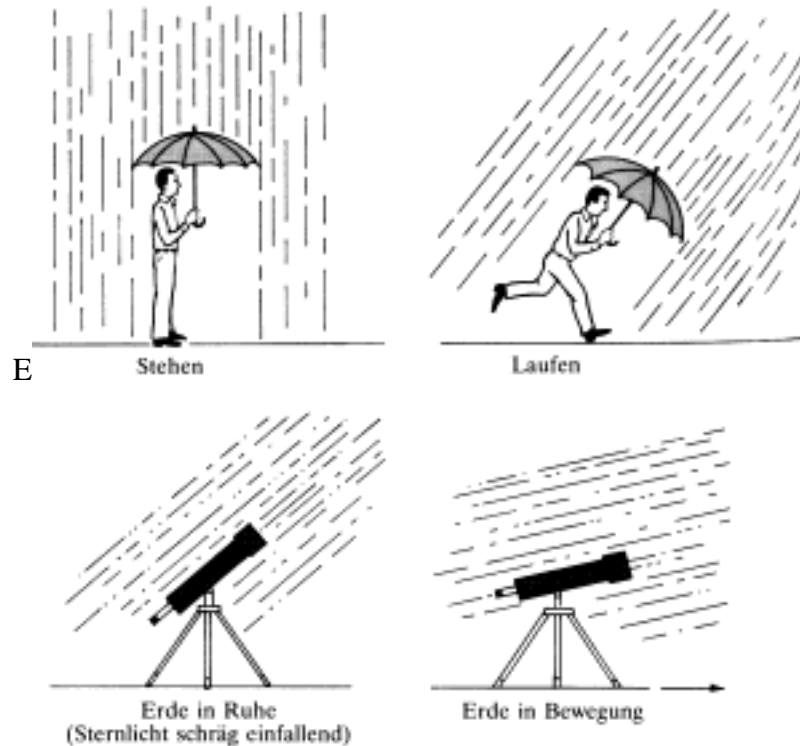
Fig. 18: Aberration des Lichtes. Oben ein analoges Beispiel mit fallendem Regen. Unten die dazu äquivalente Zeichnung mit Licht (aus Hoffmann).
